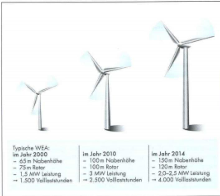
In den vergangenen Jahren haben Windkraftanlagen eine enorme Entwicklung gemacht und produzieren immer mehr Strom. Das Ende dieser Entwicklung ist nicht abzusehen.
