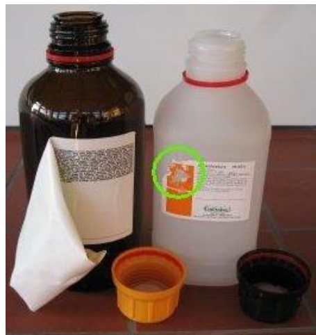
Abbildung 1 Leere Gefahrstoffgebinde mit unkenntlich gemachten Warnhinweisen
